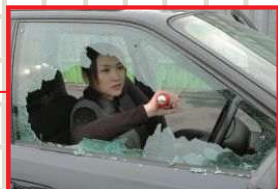
ガラスクラッシャー (ゴムキャップを装着したまま破碎可能)
